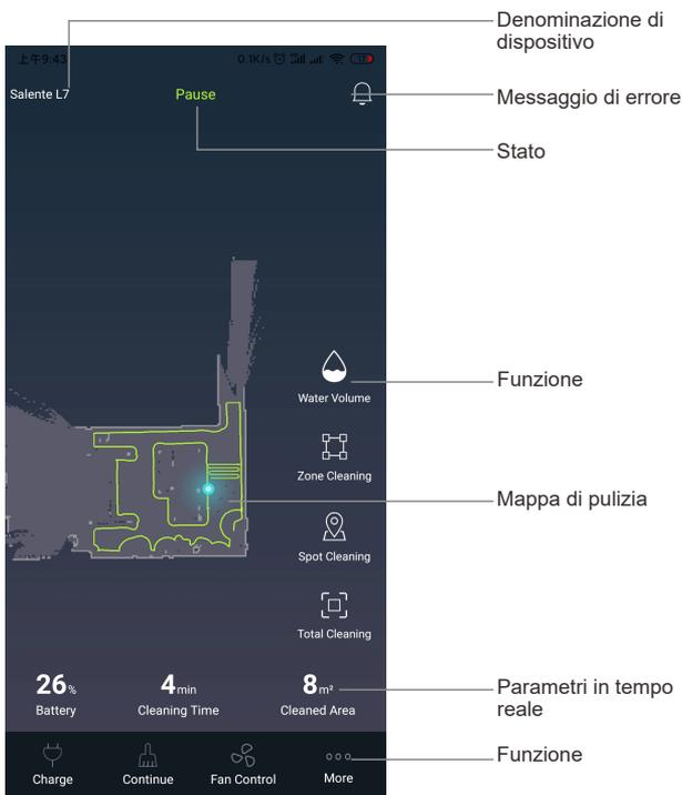
Denominazione di dispositivo: denominazione dell'aspirapolvere attualmente collegato. Messaggio di errore: Nel messaggio di errore è visualizzato l'aspirapolvere e informazioni sul fallimento del processo.
